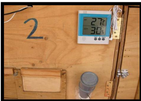
Imagen 7: Estación meteorológica, tronera para suministro de alimento y cristal-espejo para observaciones directas colocadas en el cajón 2.
